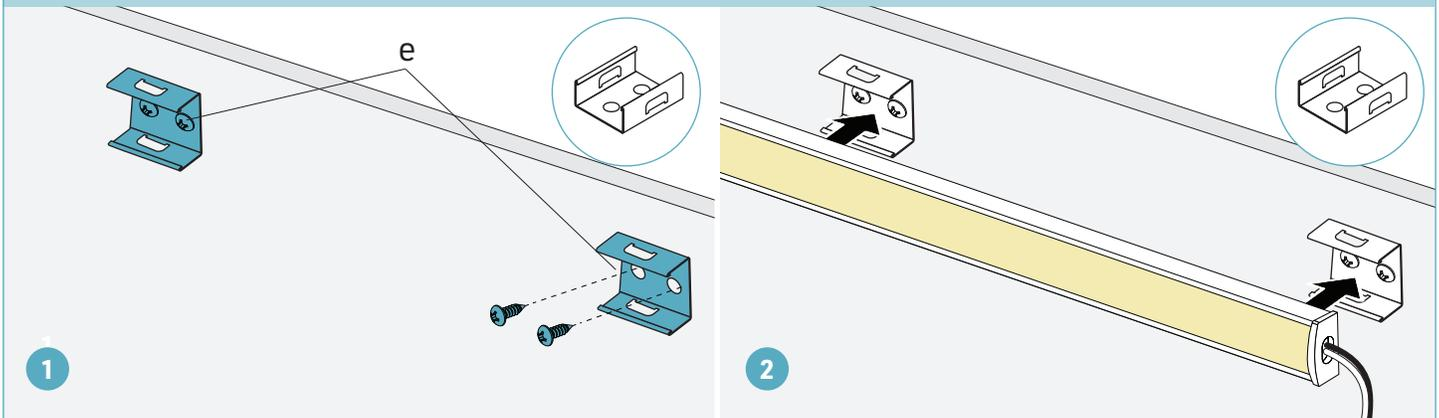
**Support pivotant intérieur 180° / Swivel bracket indoor 180°**
